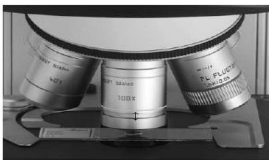
图. 55a油浸物镜 (旋下的)
