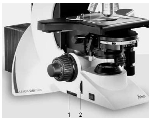
图. 58 Leica DM2500 1亮度控制 2 视野光圈控制器
