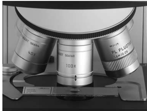
Abb. 55b Immersionsobjektiv, verriegelt
