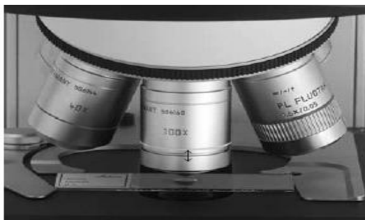
图. 55b油浸物镜 (锁定)
