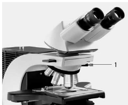
Fig. 64 Coulisseau de prismes d'objectif 1 Ajustement fin
