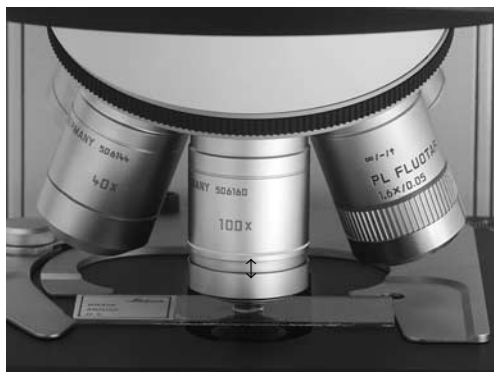
Fig. 55a Objectif à immersion, déverrouillé
