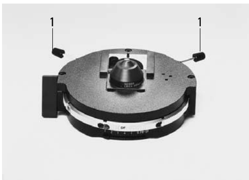
Fig. 38 Centrage des anneaux de lumière (par ex. : condenseur UCA/P)
