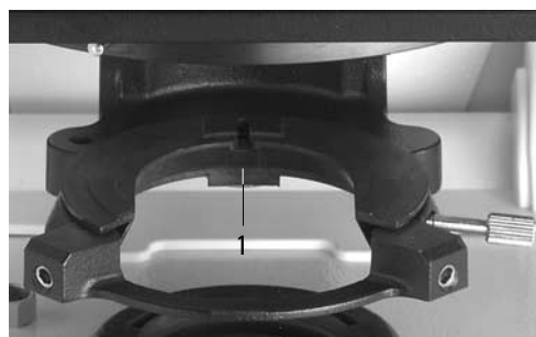
Fig. 10 Support du condenseur
