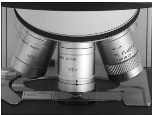
Abb. 55a Immersionsobjektiv, entriegelt
