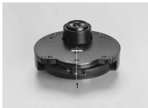
图. 72 聚光器UCL 1用于聚光器转盘的固定螺丝
